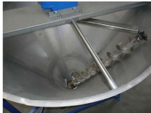
**Mischerschnecke aus Edelstahl**, Schwenkantrieb
