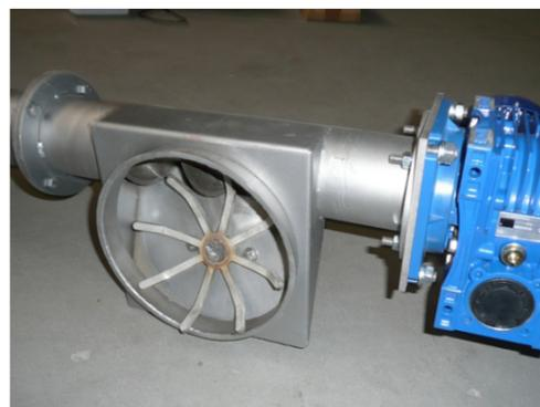
Auf Wunsch **Auslaufkasten** mit Antrieb für Förderspirale
